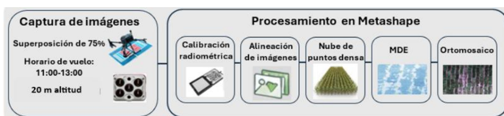
Figura 1. Adquisición y procesamiento de imágenes en Metashape para generar ortomosaicos.
